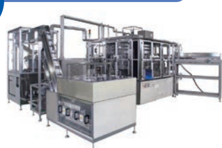
枚葉のパウチにスパウトを熱溶着し、さまざまな検査も可能
